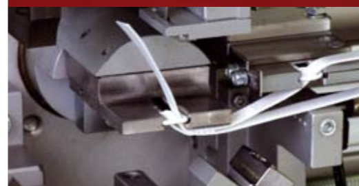
Montage automatique d'une bretelle complète
